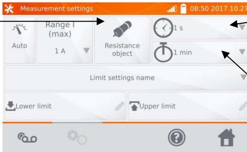
Selecting the time interval: 1 s, 5 s, 10 s, 15 s, 1 min, 5 min, 10 min, 15 min.
